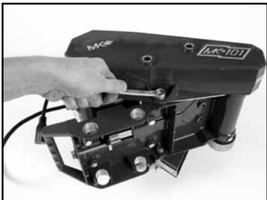
(D) Remove Belt Guard bottom bolt
