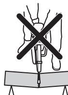
Si el disco se atasca o se engancha en el sector de riesgo de reculada, la fuerza reactiva empujará la cortadora hacia arriba y hacia atrás en dirección al usuario con un movimiento giratorio, lo que podría provocar daños graves o mortales. Preste atención al posible movimiento de la pieza de trabajo. Si la pieza de trabajo no está correctamente sujetada y se mueve durante el corte, se podría atascar el disco y provocar una violenta sacudida.
