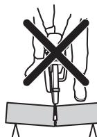
Caso a lâmina fique presa ou entalada na zona de retrocesso, a força reactiva faz com que a máquina seja arremessada para cima e para trás num movimento rotativo, podendo causar ferimentos graves e mesmo mortais. Tenha atenção à possibilidade de deslocação da peça em que está a trabalhar. Se a peça em que está a trabalhar não estiver devidamente apoiada e se deslocar durante o corte, poderá prender a lâmina e provocar um retrocesso.
