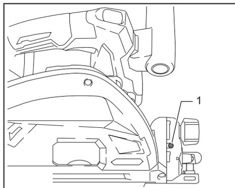
► 1. Perno de ajuste para el corte a 45°
