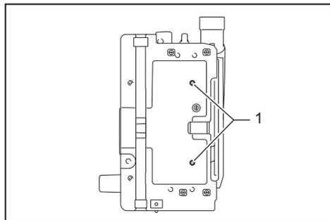
► 1. Perno de ajuste para el corte a 0°
