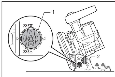
► 1. Topo de seguridad 2. Tornillo de fijación
