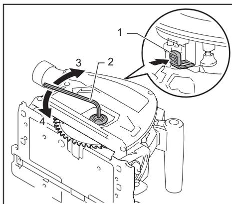
► 1. Bloqueo del eje 2. Llave hexagonal 3. Apretar 4. Aflojar
